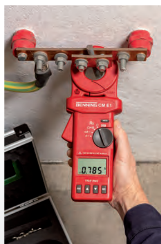
Meting van de aardlusweerstand van een systeem-aardelektrode
