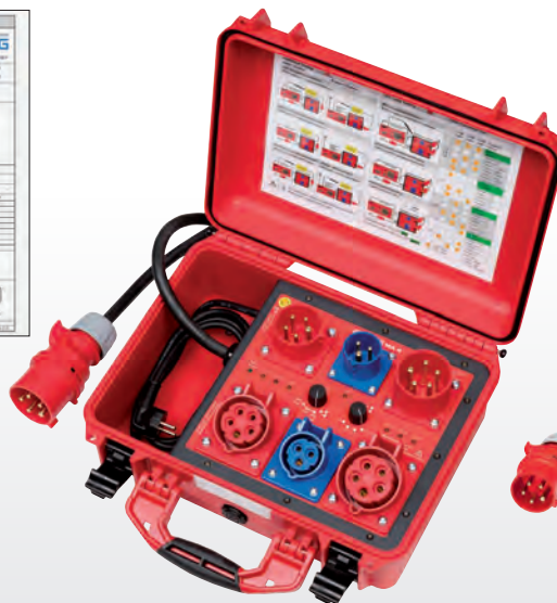
Meetadapter met koffer MA 4 (actief/passief) (044162)
