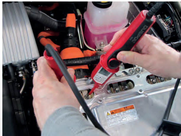
Testen van de hoge gelijkspanning van een HV-elektrisch voertuig
