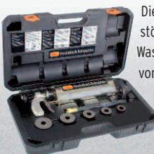
Die **Hochdruck-Rohrpistole** setzt zum Aufbrechen einer Rohrverstopfung Druckluftstöße von bis zu 11 bar ein, die sich als Stoßwellen (kinetische Energie) durch das Wasser vorwärts bewegen und gegen die Verstopfung schlagen. Verstopfte Abläufe von Waschbecken, Toiletten und Badewannen können schnell und einfach freigelegt, Ablagerungen von Rost, Fett und Krusten in Leitungen bis zu 100mm Ø entfernt werden. Besonders praktisch bei bogenreichen Rohrleitungen und engen Geruchsverschlüssen.
